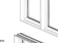
**12.** À l'aide d'un maillet, marteler le couvre-joint extérieur pour l'agripper dans les rainures des cadres / Using a mallet, hammer the exterior coupler to clip it into the frames grooves.
