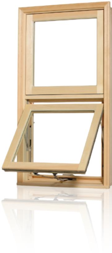
Ces fenêtres comptent sur une construction structurale, un seuil monopièce incliné, l'utilisation de coupe-froid et de verre scellé pour garantir leur solidité exceptionnelle, leur résistance aux infiltrations d'air et d'eau et leur rendement énergétique supérieur. Les fenêtres à auvents s'ouvrent du bas vers l'extérieur, grâce à un système de levier réglable. Ce mode d'ouverture permet une très bonne ventilation dans toute la maison, même les jours de pluie.
